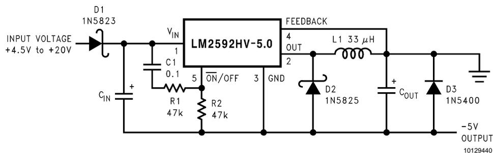
$C_{IN}$  — 68  $\mu\text{F}/25\text{V}$  Tant. Sprague 595D
