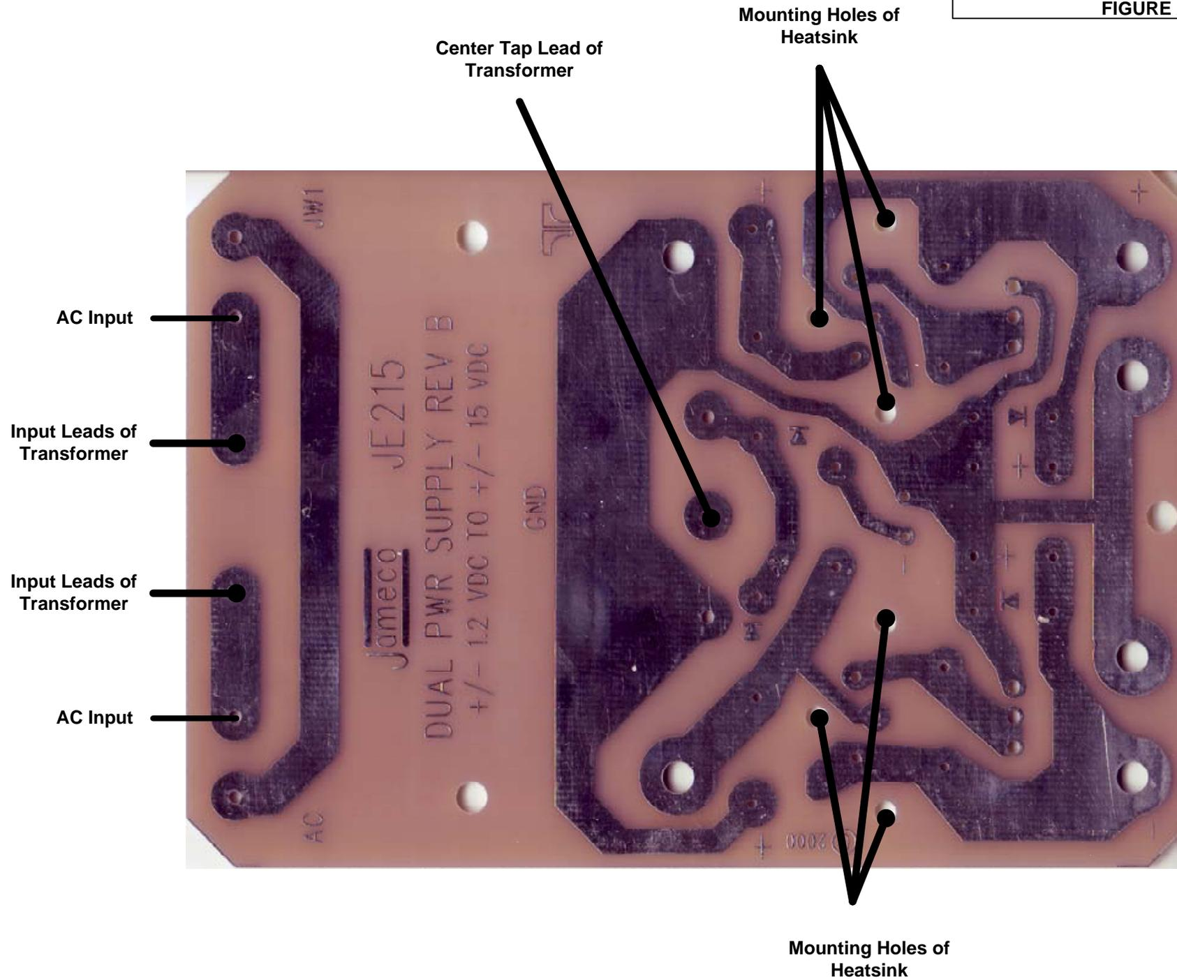
COMPONENT LAYOUT (COMPONENT SIDE OF PRINTED CIRCUIT BOARD)
