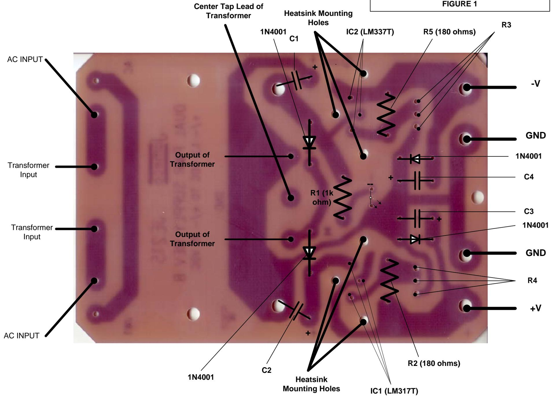
PRINTED CIRCUIT BOARD SOLDER SIDE
